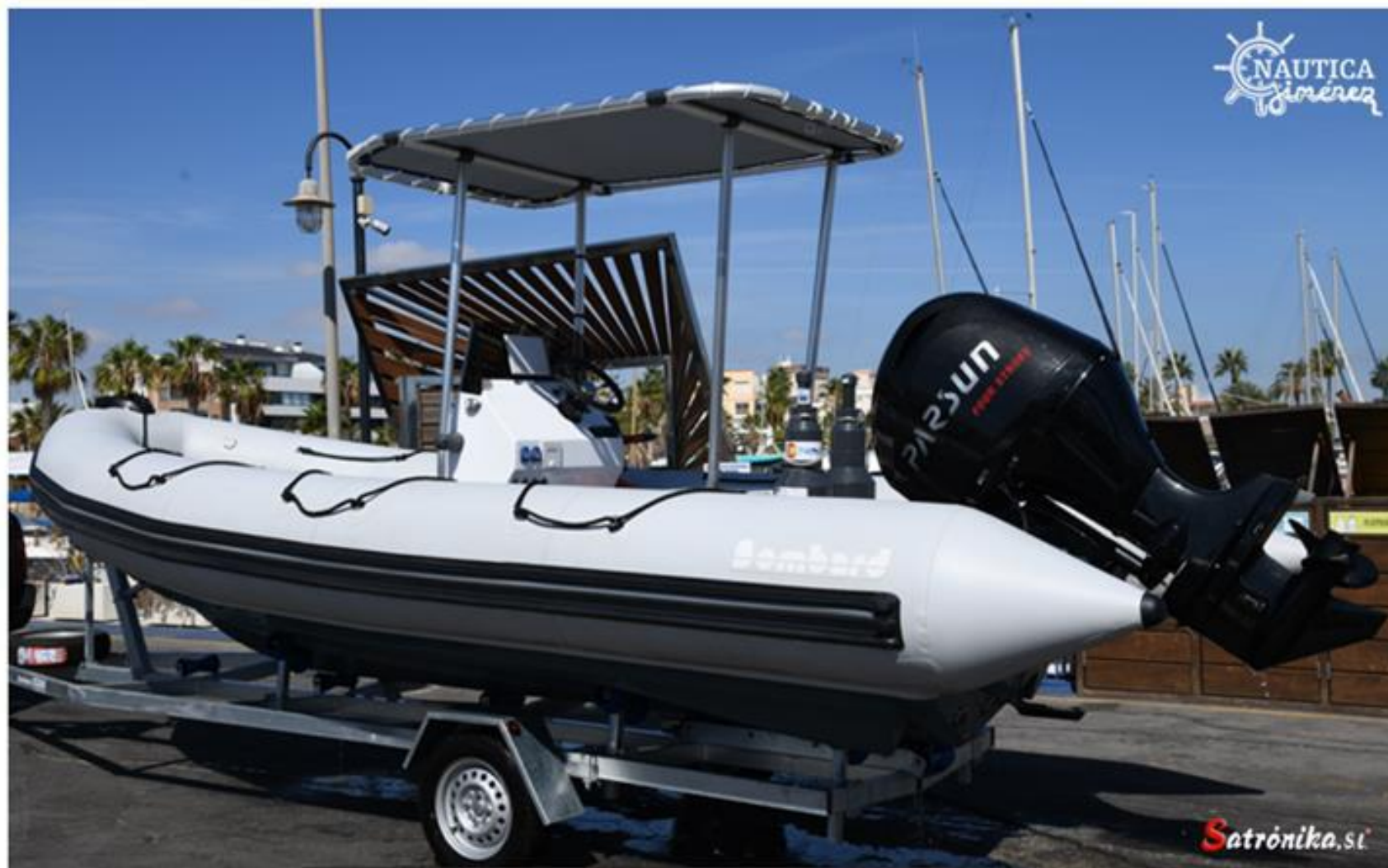
Embarcación semirrígida para toma de datos marinos, sistema de navegación autónomo para campañas de toma de datos con ADCP, CTD de alta frecuencia, sonda SUNA V2, sonda eco batimétrica EA440 y sistema AIS
